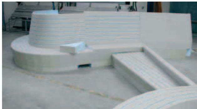
Alle Trägerelemente wurden im Werk maßgenau vorgefertigt, in den Produktionshallen aufgebaut und auf Passgenauigkeit überprüft.
